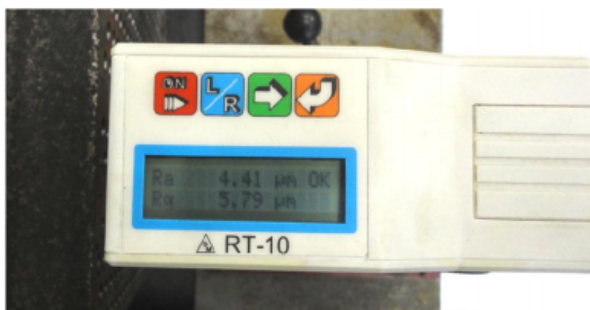
Fig. 7. Rugosímetro realizando medição em furo de uma das placas de ferro fundido nodular.
